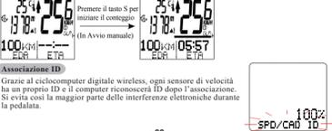
In qualsiasi modalità, premere i tasti A e M contemporaneamente per 6 secondi, quindi premere il tasto S per iniziare l'associazione ID. Nel frattempo, usare il magnete sui raggi per svegliare il sensore di velocità per l'accoppiamento ID.
