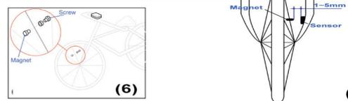
Den Geschwindigkeitsmagneten mit einer Schraube an einer Speiche des Vorderrads anbringen. Sicherstellen, dass die Magnetseite zum Geschwindigkeitssensor ausgerichtet ist. Der Abstand zwischen Geschwindigkeitssensor und Speichenmagnet darf höchstens 5 mm betragen. Nach korrektem Anbringen der oben genannten Positionen ist das Gerät einsatzbereit. Hinweis: Bitte prüfen Sie vor der Benutzung des Fahrrads, dass alles richtig eingerichtet wurde.
