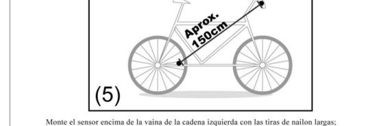
Monte el sensor encima de la vaina de la cadena izquierda con las tiras de nailon largas; asegúrese de que el lado de la cadencia mira hacia adelante y el lado de la velocidad mira hacia atrás. La distancia entre el sensor y el ciclocomputador debe ser de aprox. 150 cm.
