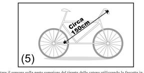
Montare il sensore sulla parte superiore del tirante della catena utilizzando le fascette in nylon più lunghe, verificare che il lato cadenza sia rivolto in avanti e il lato velocità sia rivolto indietro. La distanza tra il sensore e il computer per bicicletta sarà di circa 150 cm.
